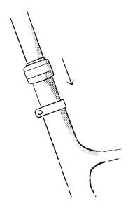
INSERT THE DROPPER POST INTO PROPERLY LUBRICATED SEAT TUBE. BE SURE TO INSERT POST BEYOND MINIMUM INSERTION LINE ON POST.
